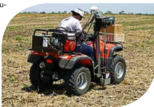
Quadriciclos são equipados com GPS, computador de bordo e dotado com amostrador próprio.
